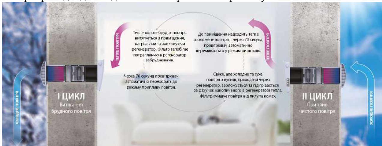
Рис. 1. Принцип роботи провітрювача Vents Twin Fresh [1]
